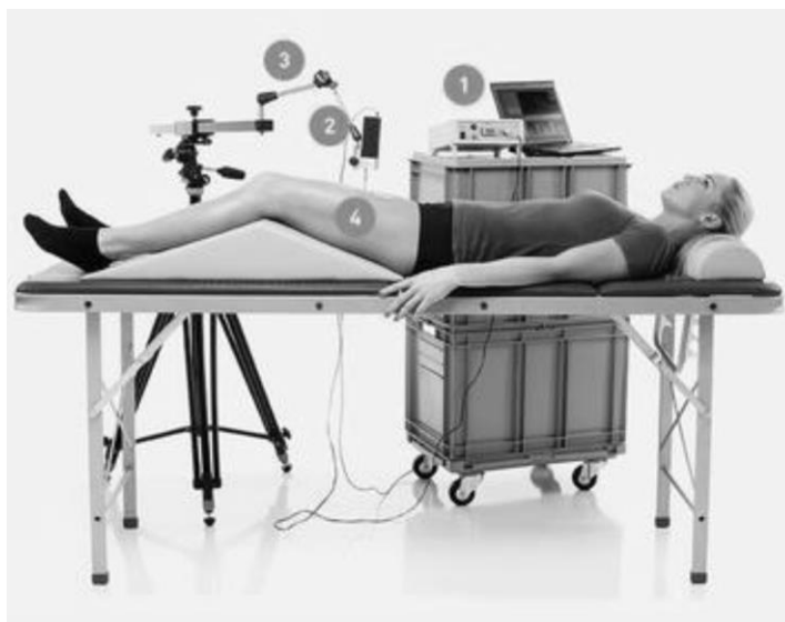
Slika 2. TMG se sastoji od: 1. Električni stimulator, 2. Digitalni senzor pomaka (TMG), 3. Tronožac sa manipulativnom rukom, 4. Mišićne elektrode (izvor: www.tmg-bodyevolution.com , 2013.)
