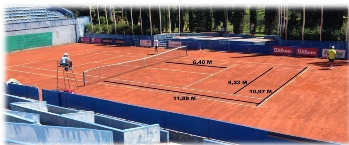
SLIKA 1. Dimenzije teniskog terena
