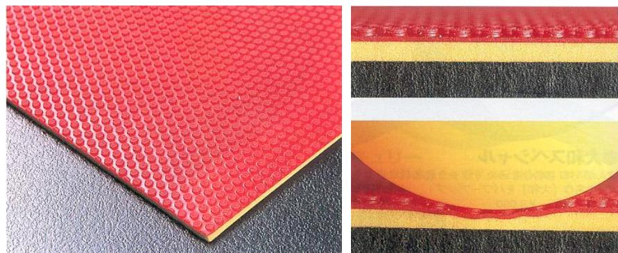
*Slika 5. Guma sa kratkim zupcima okrenutim prema van i spužvastom podlogom – „soft“ (izvor: Munivrana, 2011.)*
