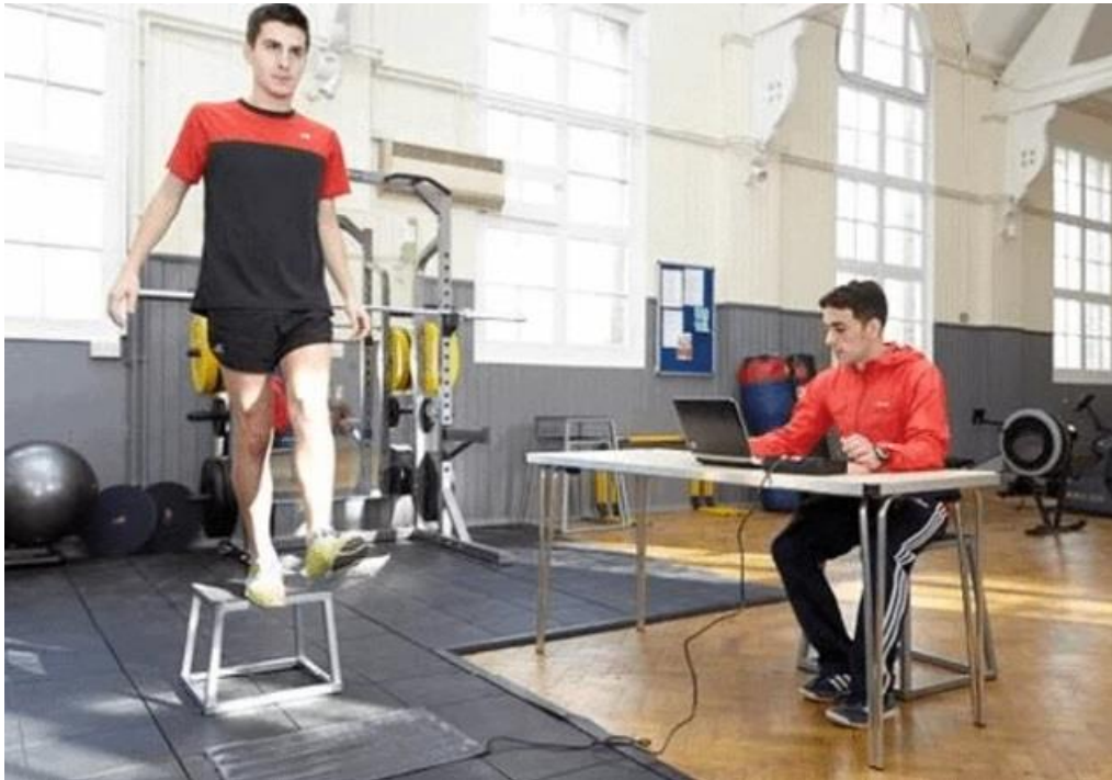
Slika 7. RSI test s tenziometrijskom platformom
