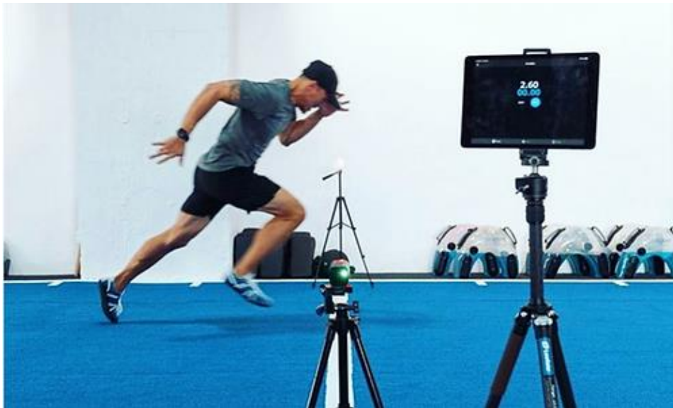
Slika 2. Mjerenje maksimalne brzine trčanja fotočelijama.
