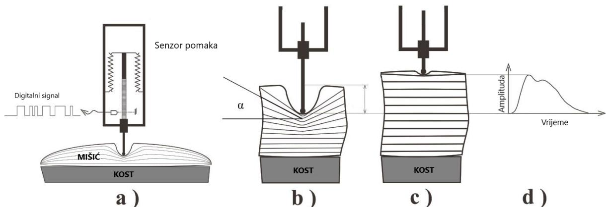
*Slika 3. Pricip TMG metoda: linearni senzor pomaka (a) se podesi na opušten mišić (b) čiji se trbuš zadeblja tijekom elektrostimulacije te vertikalno potisne senzor pomaka (c) i izmjeri mehanički odgovor na električnu stimulaciju (d). (Preuzeto iz Šimunič i sur., 2010)*
