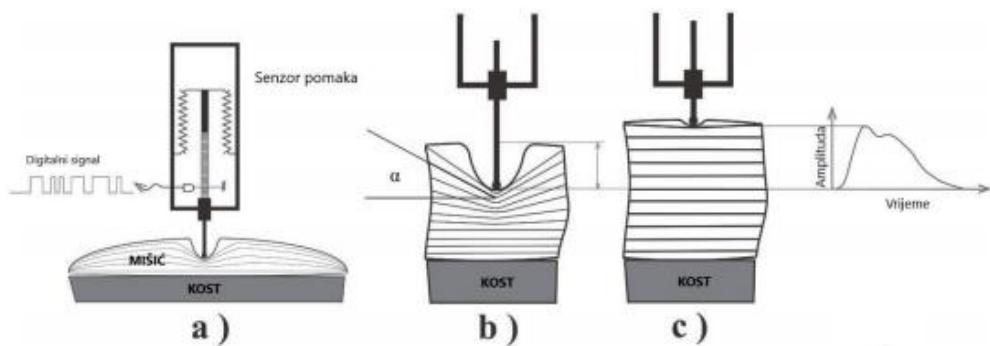
*Slika 3. Pricip TMG metode: linearni senzor pomaka (a) se podesi na opušten mišić (b) čiji se trbuh zadeblja tijekom elektrostimulacije te vertikalno potisne senzor pomaka (c) i izmjeri mehanički odgovor na električnu stimulaciju
