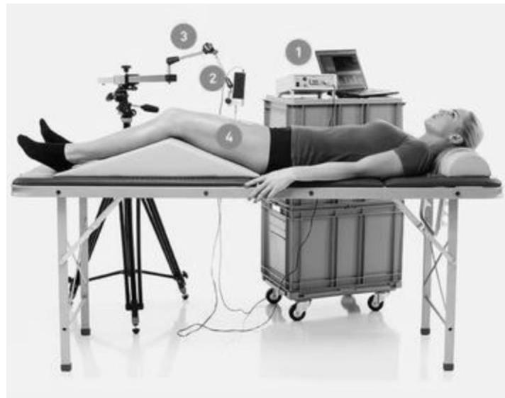
*Slika 2. TMG se sastoji od: 1. Električni stimulator, 2. Digitalni senzor pomaka (TMG), 3. Tronožac sa manipulativnom rukom, 4. Mišićne elektrode
