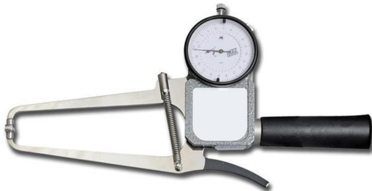
Slika 2. Kaliper, uređaj za mjerenje kožnih nabora [izvor: https://www.medical-centar.hr/proizvod/kaliper-profesionalnimehanicki/ , posjećeno: 09.09.2021.]
