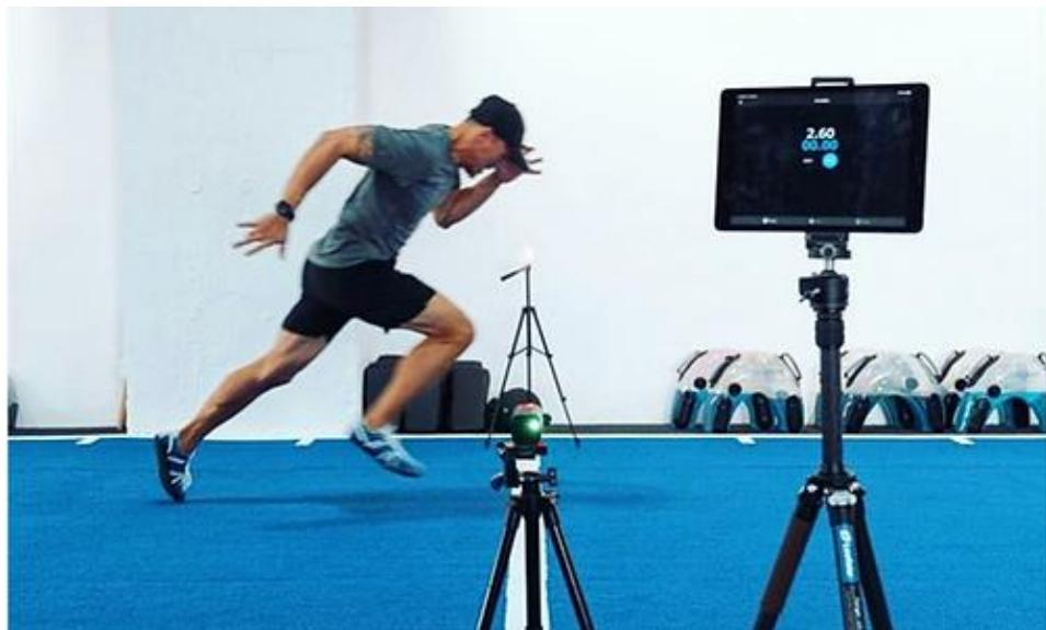
*Slika 2. Mjerjenje maksimalne brzine trčanja fotoćelijama.*
